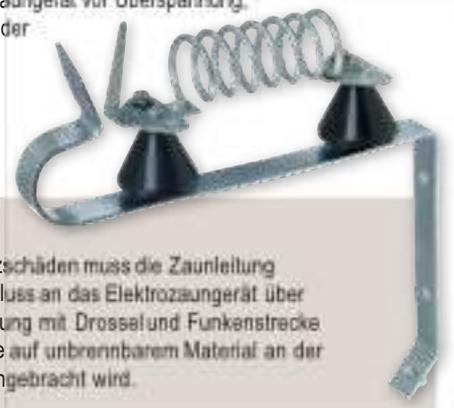
Zur Verhütung von Blitzschäden muss die Zaunleitung am Gebäude vor Anschluss an das Elektrozaungerät über eine Blitzschutzvorrichtung mit Drossel und Funkenstrecke geführt werden, welche auf unbrennbarem Material an der Gebäudeaußenwand angebracht wird.
