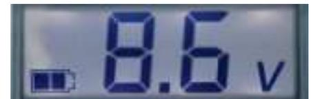
Batterieversorgungsspannung in Volt und Batteriezustandsymbol
