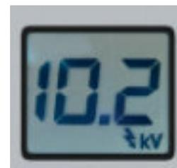
**Zaunausgangsspannung:** Anzeige der Ausgangsspannung in Kilovolt. Kleinste Veränderungen des Zaunzustands können somit erkannt werden.
