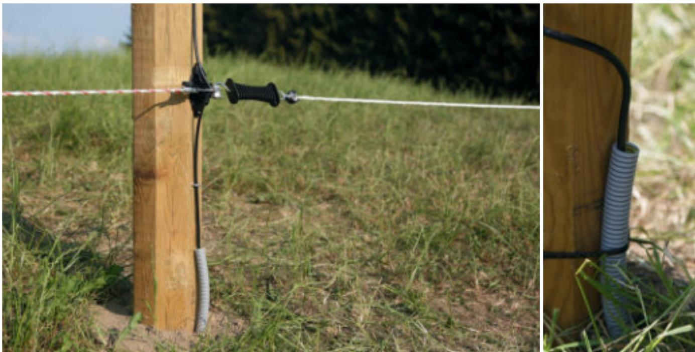
Tip: Untergrundkabel unbedingt in einem Kunststoffleerrohr verlegen, um Beschädigungen am Kabel zu verhindern!
