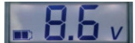
Batterieversorgungsspannung in Volt und Batteriezustandsymbol
