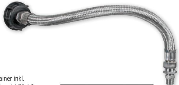
Lieferumfang: 1 x Panzerschlauch 70 cm (Anschluss 2 x 3/4" IG), 1 x Adapter für IBC-Container inkl. Dichtung (S60 x 6 auf 3/4" AG), 1 x Reduzierung gerade 3/4" AG auf 1/2" IG, 1 x Doppelnippel 1/2" AG auf 1/2" AG, 1 x Doppelnippel 3/4" AG x 3/4" AG
