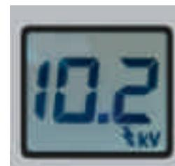
Zaun Ausgangsspannung: Anzeigeter Ausgangsspannung in Kilovolt. Kleinste Veränderungen des Zaunzustands können somit erkannt werden.
