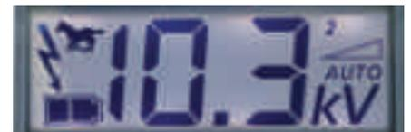
Ausgangsspannung in Kilovolt
