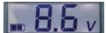
Batterieversorgungsspannung in Volt und Batteriezustandsymbol
