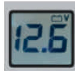
Batteriespannung: Zeigt die aktuelle Batteriespannung in Volt an. Die 12 Volt Batterie soll bei min. 12 Volt Spannung liegen - ideal wären größer 12,5 Volt.
