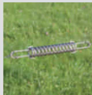
4. Die Befestigung auf der anderen Seite wiederholen und Feder mit dem rotierenden Spanner vorspannen
