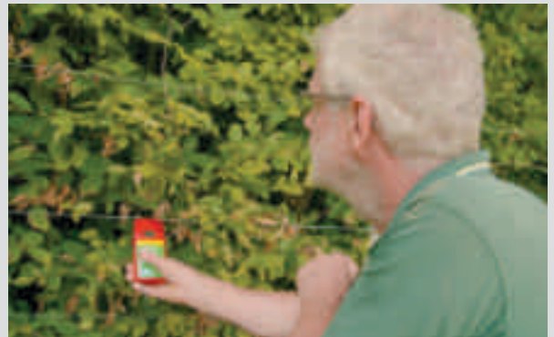
Auch bei extrem stark bewachsenen Zäunen ermöglicht das P8000 Zaunspannungen von weit über 5000 Volt.
