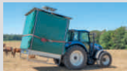
Transport über Dreipunkthängung, ungefüllt mit max. 10 km/h, mit eingeklappten Dachsegmenten
