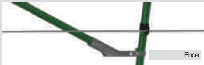
90° Ecken-Set für T-Pfostenzäune, stabil und leicht einzubauen
