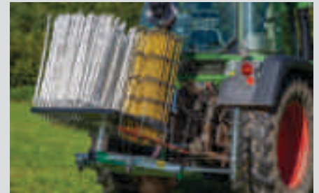
Wechselbares Magazin für bis zu 400 Pfähle
