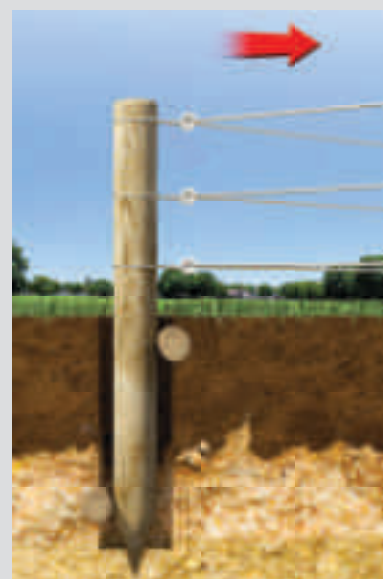
Der Eckpfahl einer Zaunanlage ist doppelt so lang wie der Zaun hoch.
