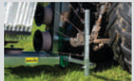
Beidseitiges Arbeiten durch umsteckbaren Auslegearm
